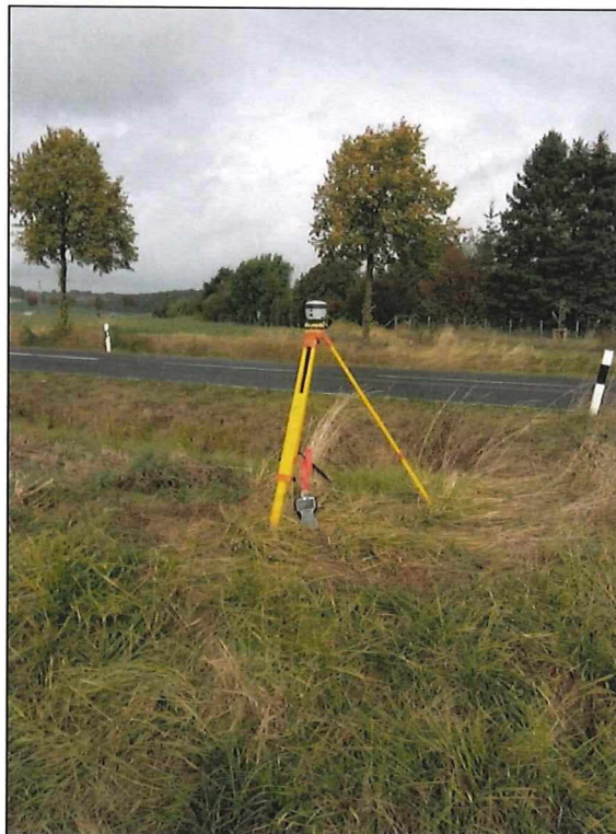
Abbildung 3: Statische Vermessung am lokalen geodätischen Netzwerkpunkt 101.
