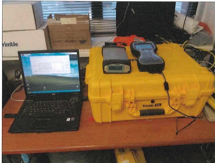
Abbildung 8: Die GPS-RTK-Referenzstation im Vermessungsbüro.
