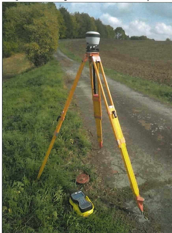
Abbildung 6: Statische Vermessung am lokalen geodätischen Netzwerkpunkt 757.
