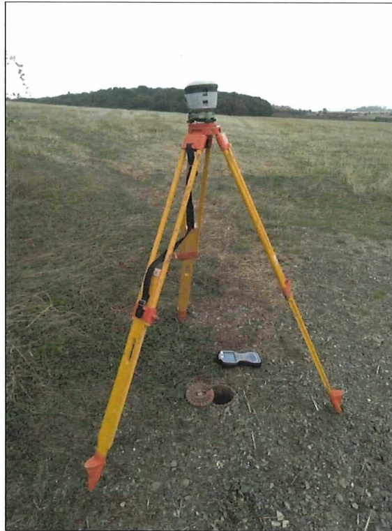
Abbildung 5: Statische Vermessung am lokalen geodätischen Netzwerkpunkt 743.
