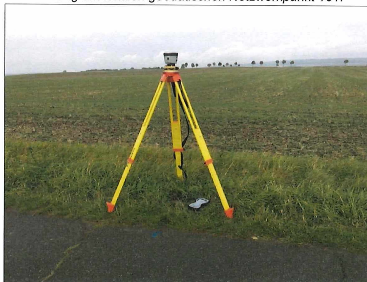
Abbildung 4: Statische Vermessung am lokalen geodätischen Netzwerkpunkt 711.
